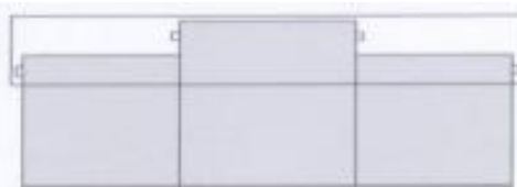
Podwójna kasetka kurtyny z wałami na różnych wysokościach. Szerokość 150 mm x wysokość 250 mm.
